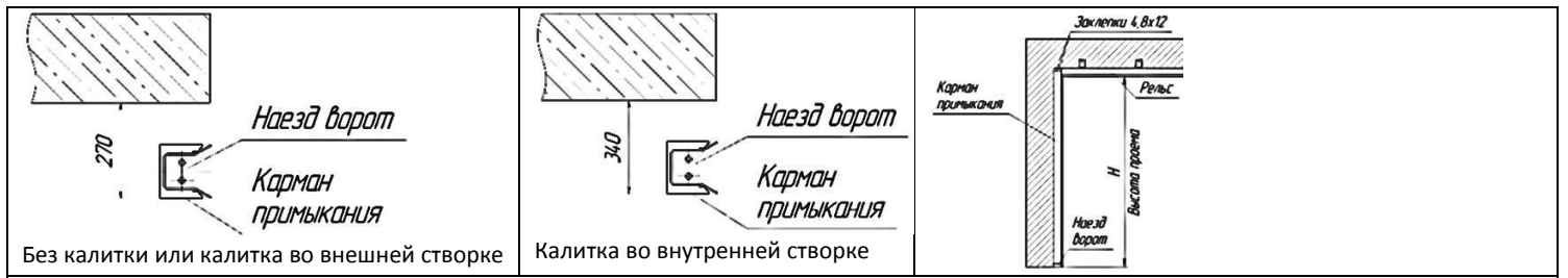
8. Монтаж наезда ворот и кармана примыкания
